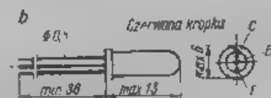
Rys. 1. Szkice rozmiarowe obudów tranzystorów TG2-TG8 a - obudowa nowego typu, b - obudowa starszego typu
